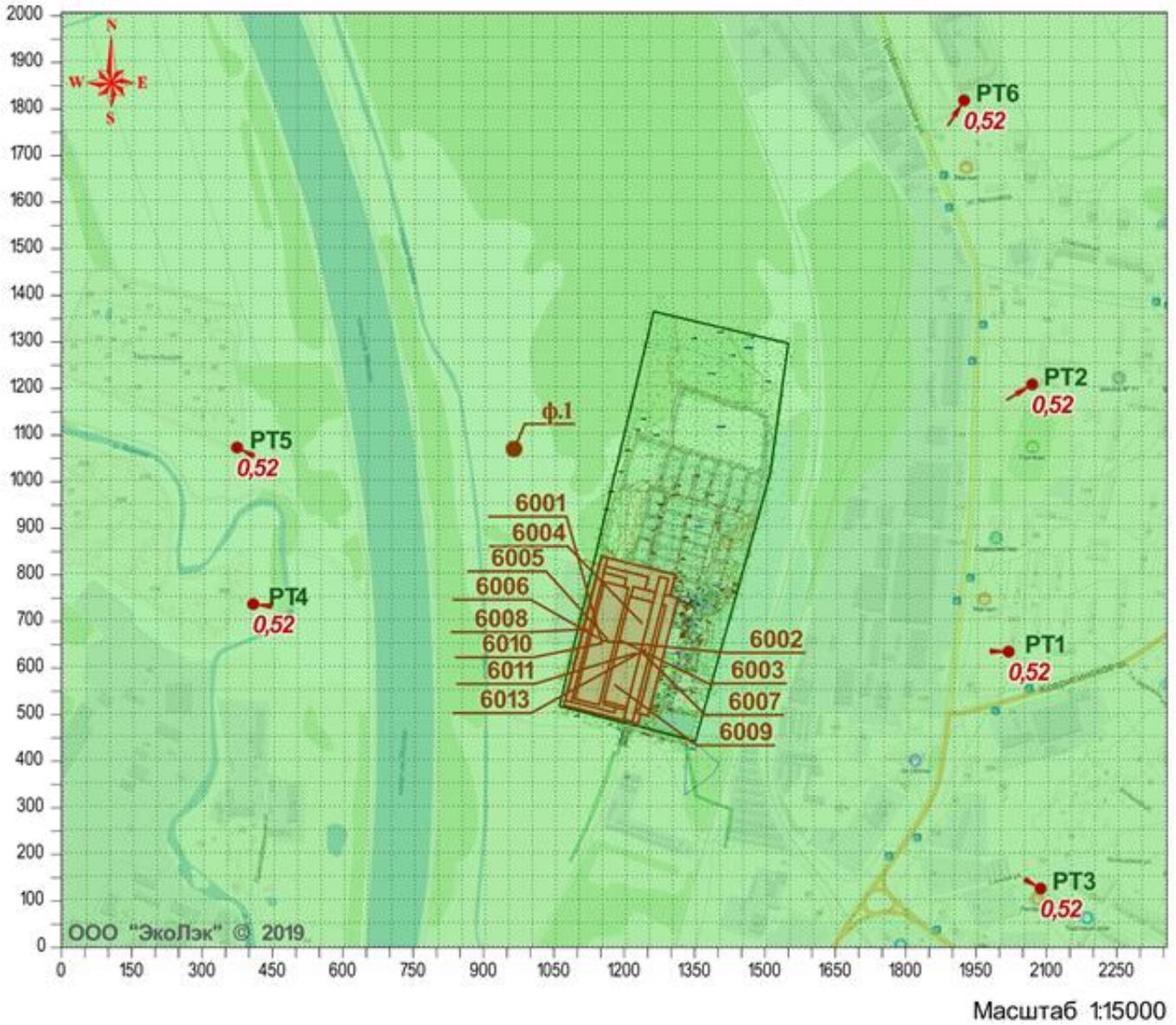
Рис. 5.1.8 Результат рассеивания вещества: Углерод оксид
