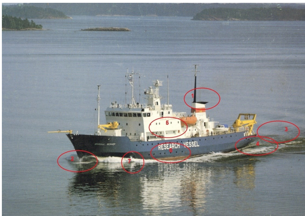
Рисунок 13.1. Основные источники воздушного шума судна
