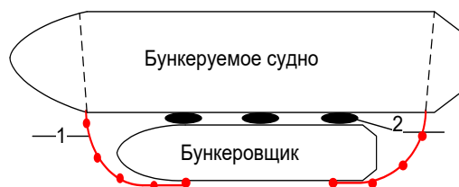
Рисунок 2.7. Ограждение бонами судов при бункеровке в акватории
