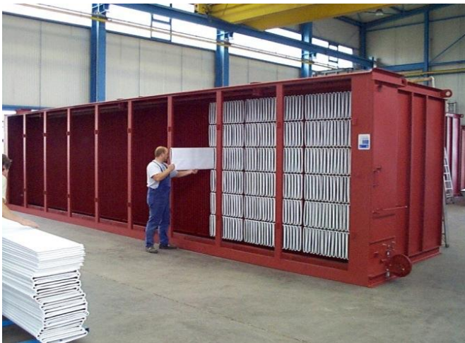
Заполнение фильтроэлементами камеры
