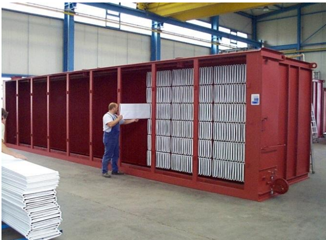
Заполнение фильтроэлементами камеры
