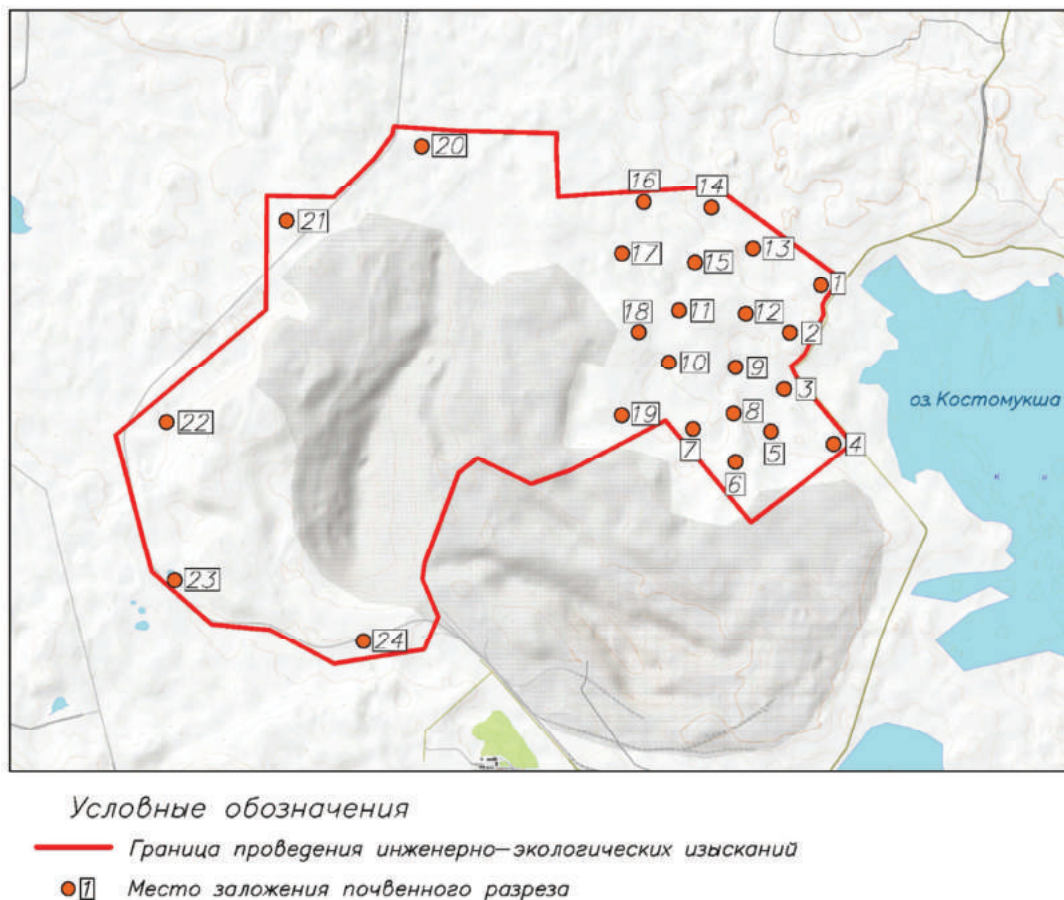
Рис. 6.1 - Схема заложения почвенных шурфов
