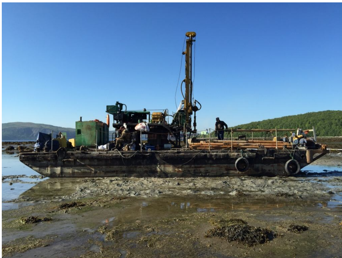
Рисунок 4.5 – Технологическая площадка (понтон) с установленным буровым станком «ПБУ-2»
