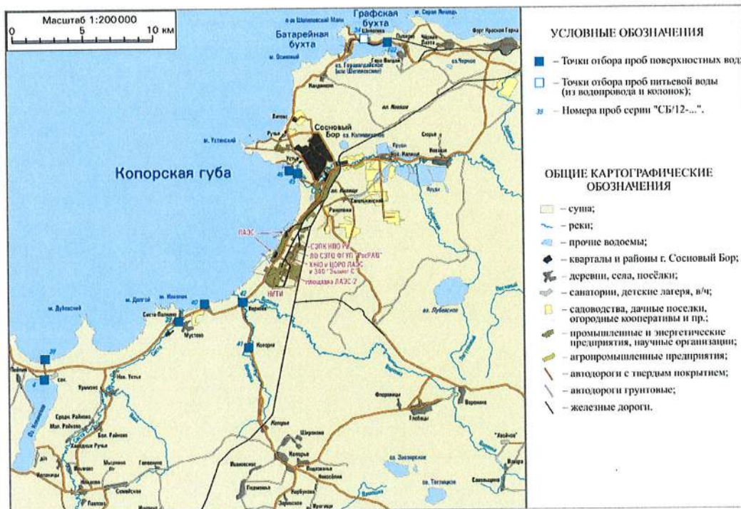
Рисунок 4.3.2.2.1.1.5 - Схема отбора проб поверхностных и питьевых вод для определения объемной активности ^{90}\text{Sr} в ЗН ЛАЭС-2 за 2012 г.
