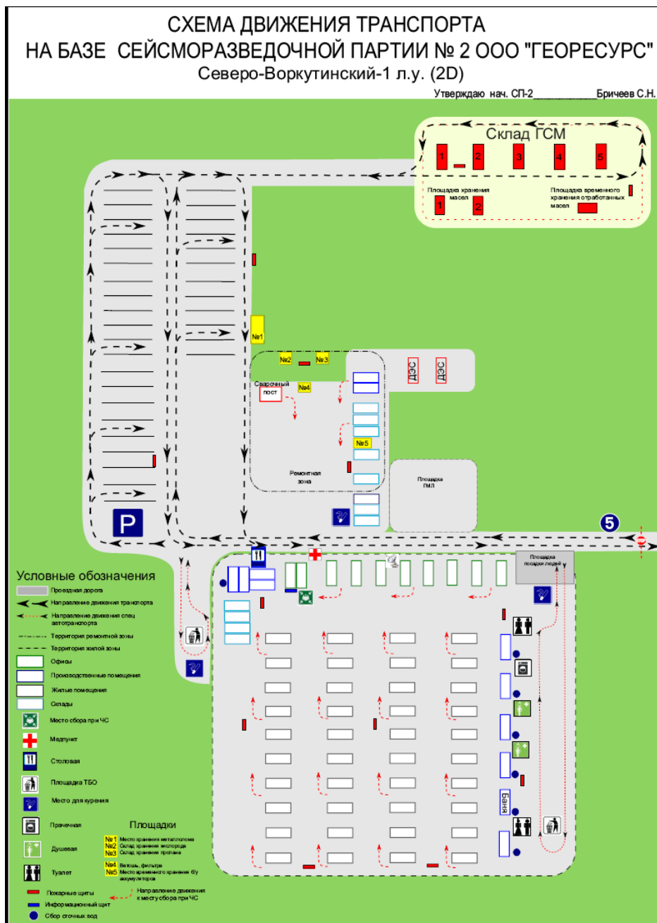
Рисунок 3.4-3. Схема обустройства базы партии и движения транспорта
