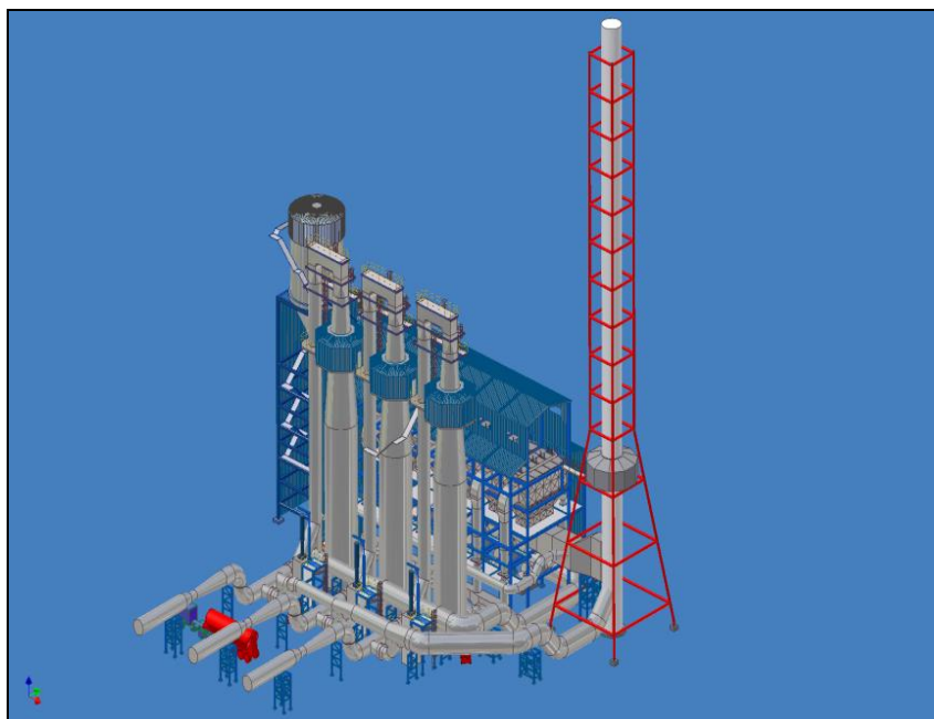
Рисунок 6.2.1.1-1. Общий вид газоочистной установки печей обжига анодов
